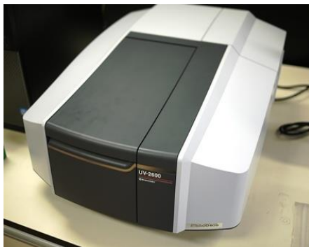
Figura 3. 21: Em a) Fotografia do espectrômetro UV - 2600 Shimadzu, e em b) representação do caminho óptico do feixe de radiação.
