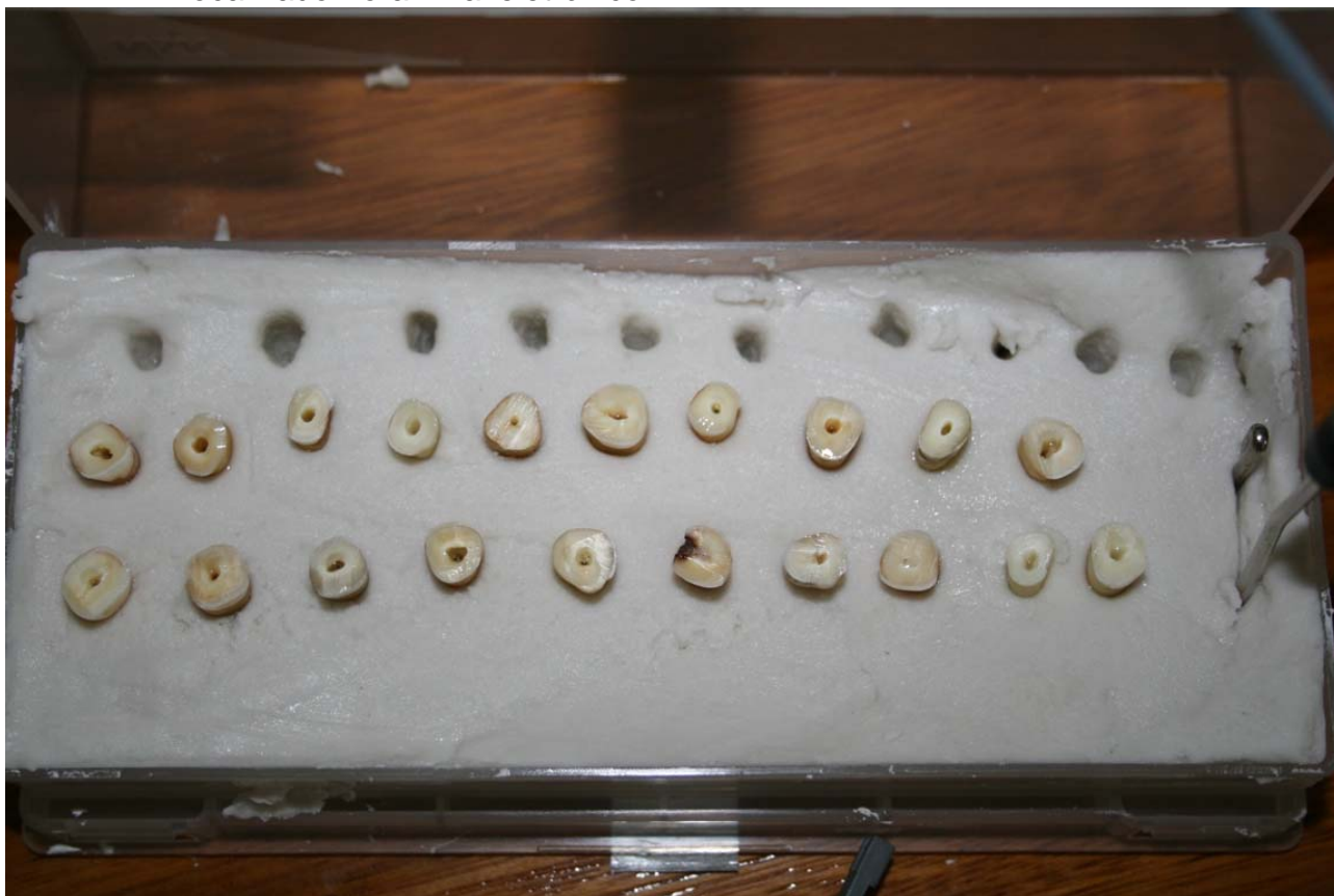
Figura 7 - Inclusão dos espécimes em alginato juntamente com o polo colgante do localizador foraminal eletrônico.
