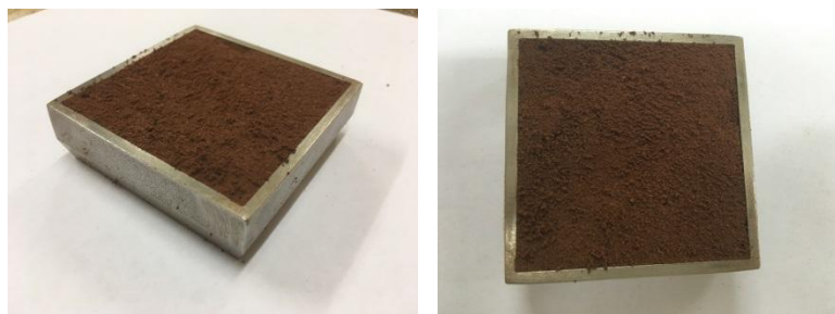
Figura 4.26 – Exemplo de CP talhado, ainda dentro do molde de aço
