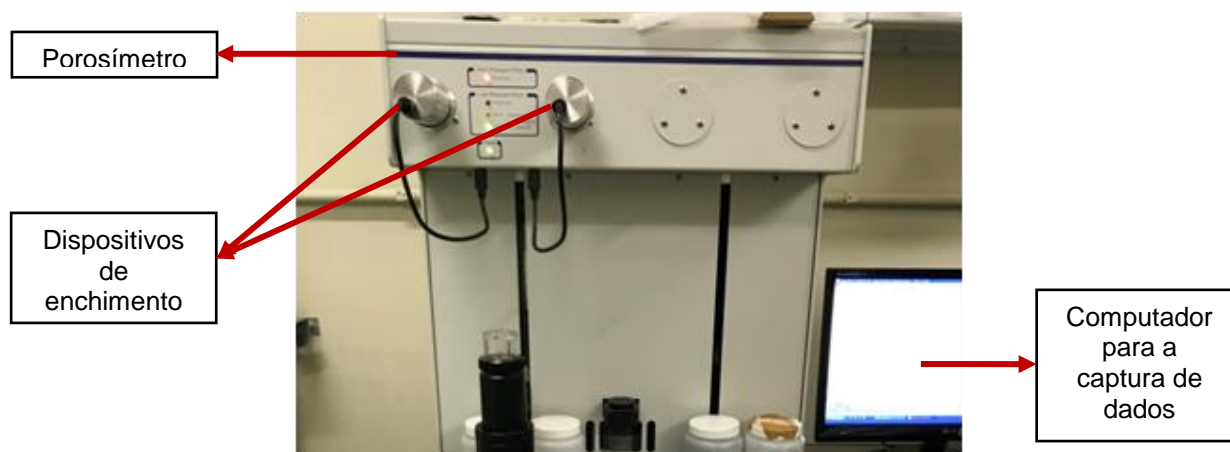
Figura 4.14 – Vista frontal do porosímetro por intrusão de mercúrio
