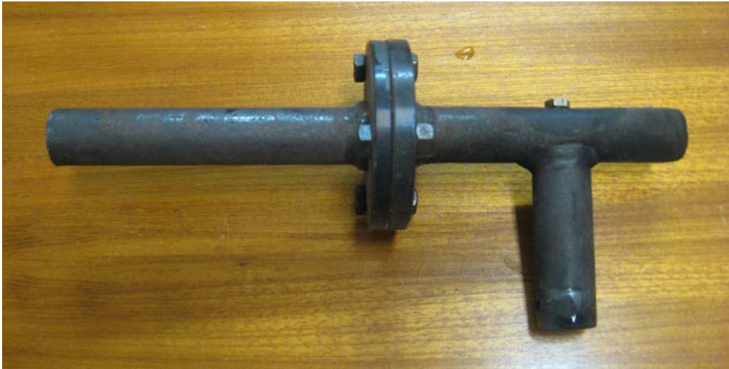
Figura 4.2 – Tubulação de aço acoplada ao escapamento para coleta de MP.
