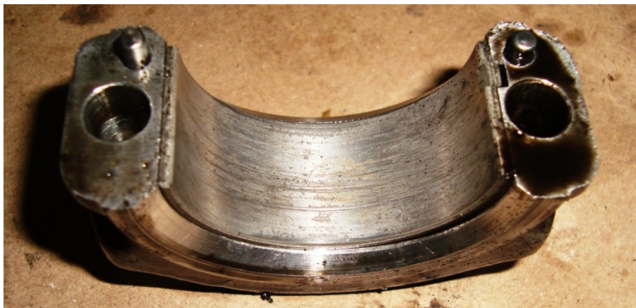
Figura 3.32 – Bronzina da capa de biela do motor alimentado com a mistura ternária.
