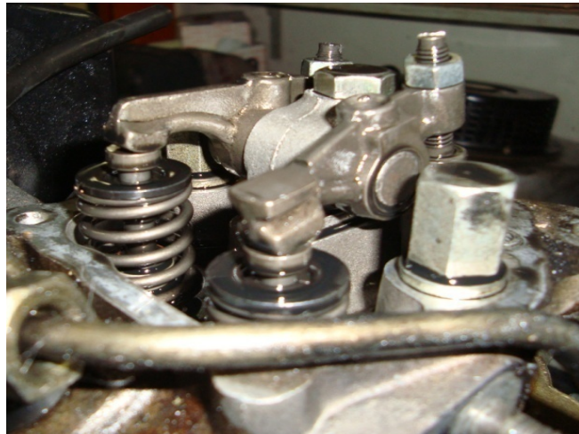
Figura 3.15 – Válvulas do motor abastecido com diesel.
