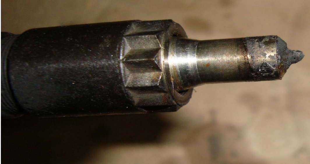
Figura 3.20 – Bico injetor após 150 horas funcionando como a mistura ternária.
