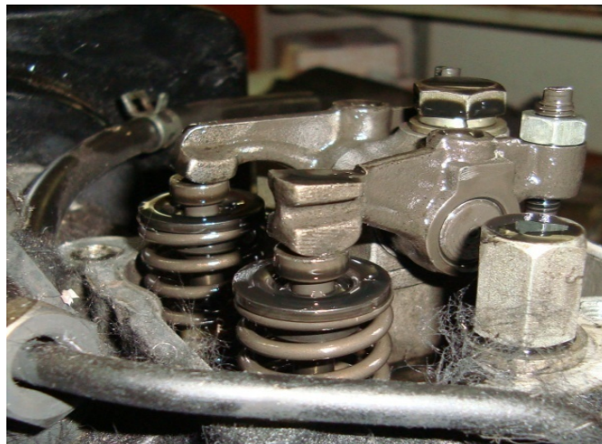
Figura 3.16 – Válvulas do motor abastecido com a mistura ternária.
