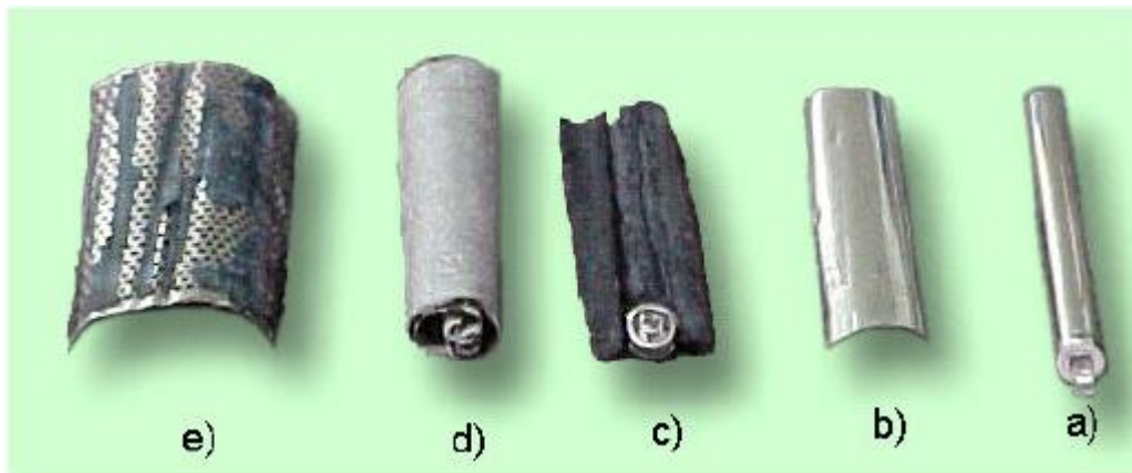
Figura 28 – a) Pilha de Ni-HM e seus componentes, b) Invólucro metálico, c) Eletrodo positivo (catodo), d) Separador, e) Eletrodo negativo (anodo).
