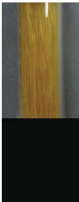
Figura 33. Amostra de linhas de nylon, inseridas em um tubo de vidro, elaborada para verificação da microtomografia de raios X.
