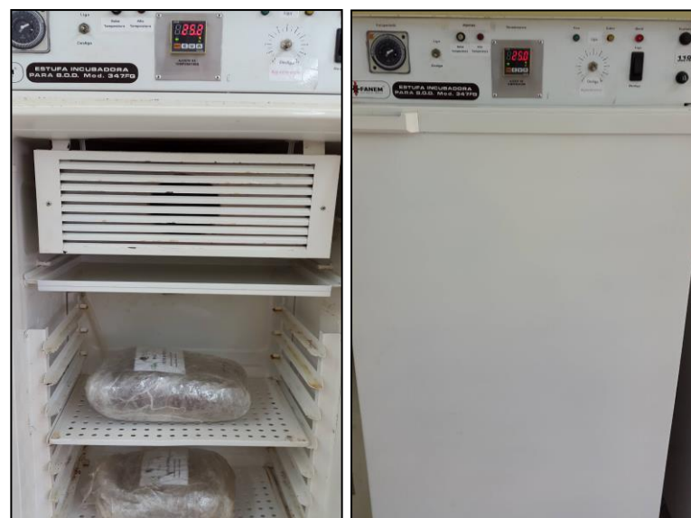
Figura 6 – Câmara incubadora com a torta de pinhão manso.
