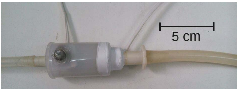
Figura 9 – Gerador de ozônio montado.
