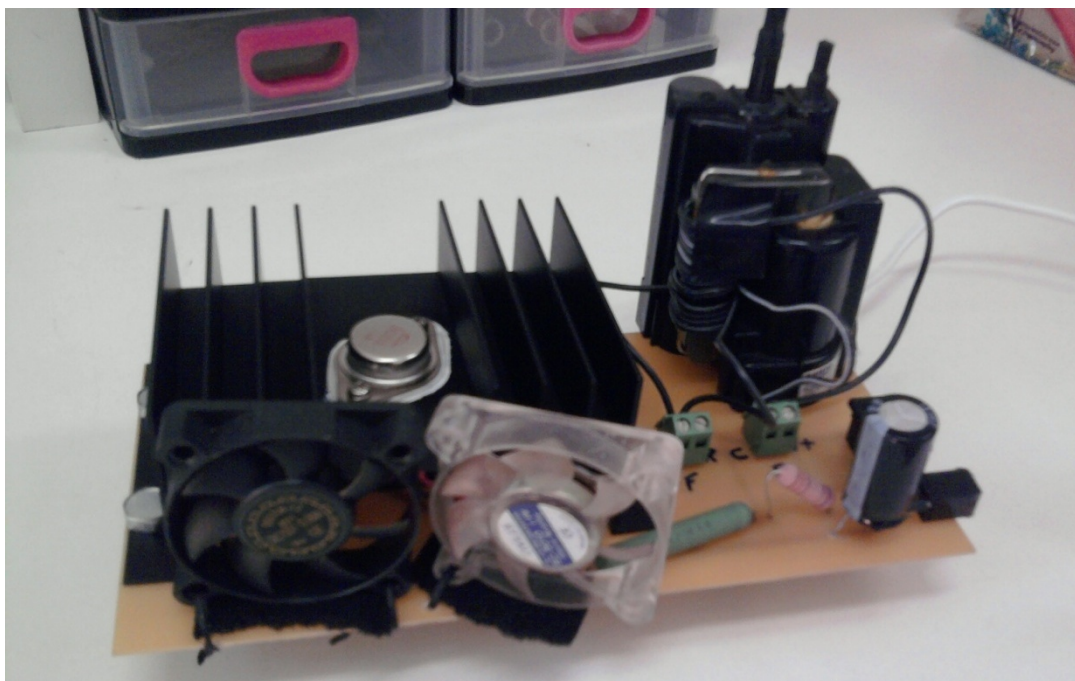
Figura 7 – Fonte de alta voltagem construída para o gerador.
