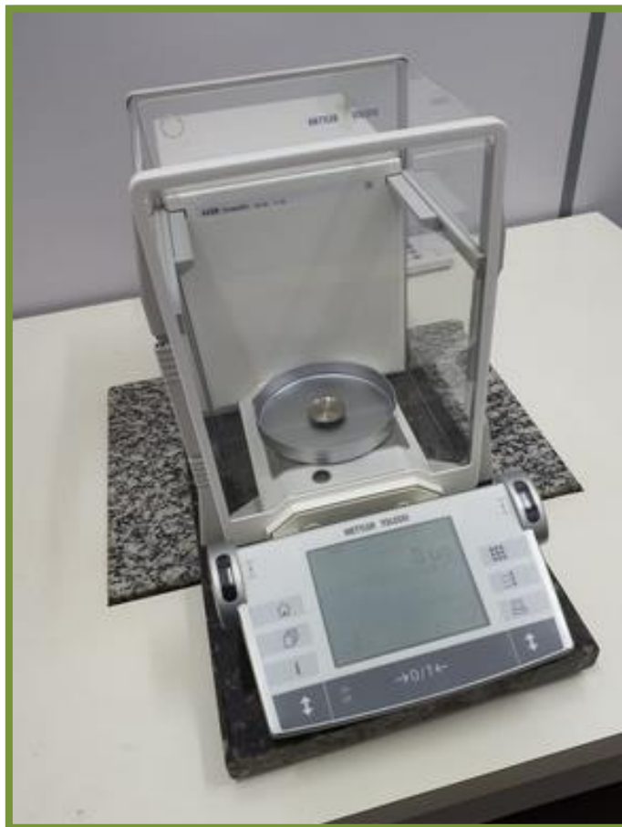
Figura 11 - Balança ultra-analítica (Mettler Toledo, AX26, Suíça) com precisão de 1,0 \mu g.
