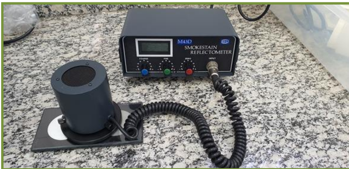
Figura 12 – Reflectômetro (EEL 43D Smoke Stain Diffusion Systems Ltd., Londres, Reino Unido) (DEFRA, 2019).
