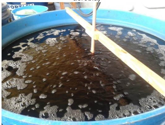
Figura 10 – Tratamento por lodos ativados (fase aeróbia)
