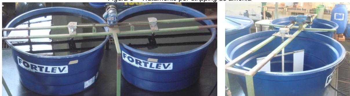
Figura 9 – Tratamento por stripping de amônia
