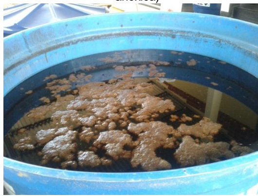
Figura 11 – Tratamento por lodos ativados (fase anóxica)
