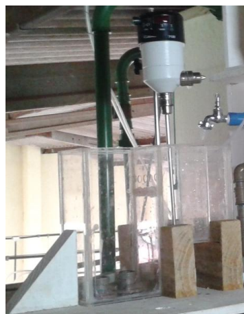
Figura 14 – Foto do compartimento de mistura rápida com agitador (Fisaton 713-D)
