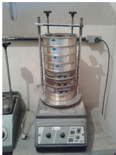
Figura 30 – Foto do agitador de peneiras utilizadas para caracterização de material fino/areias
