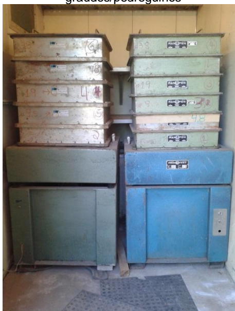
Figura 29 – Foto das plataformas agitadoras utilizadas para caracterização de agregados graúdos/pedregulhos
