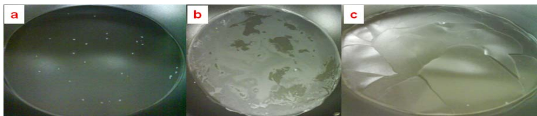
Figura 12 – Presença de defeitos tecnológicos em filmes produzidos em diferentes concentrações dos componentes amido, glicerol e celulose, a: alta concentração de amido; b: baixa concentração de amido; c: baixa concentração de glicerol.
