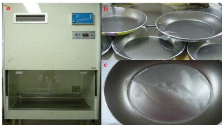
Figura 5 – Procedimentos de esterilização e moldagem por casting dos biofilmes: a. Câmara de fluxo laminar com luz UV; b. Recipiente com material antiaderente para moldagem da solução filmogênica; c. Biofilme moldado sobre a superfície antiaderente de fundo circular
