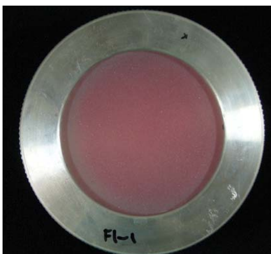
Figura 8 – Vista superior da cápsula contendo o corpo de prova do biofilme para o teste de permeabilidade ao vapor de água
