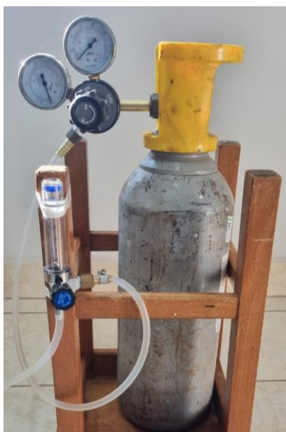
Figura 29 – Cilindro de CO 2 e válvulas
