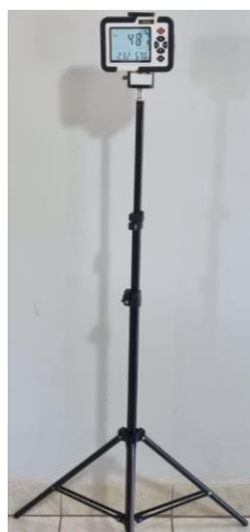
Figura 31 – Conjunto de sensor de CO 2 e tripé metálico
