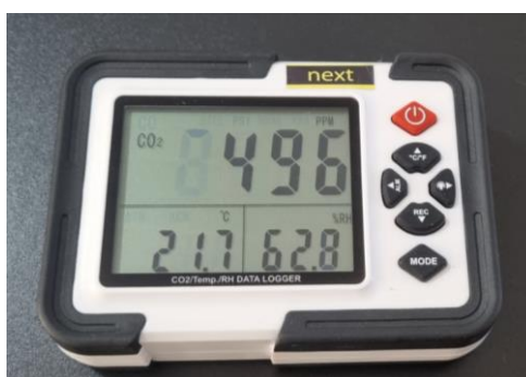
Figura 30 – Sensor NDIR de CO 2 com termo-higrômetro
