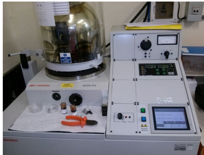
Figura 43. Imagem da Evaporadora EDWARDS EVAPORADOR® 306 Auto do DiNE da UFPR
