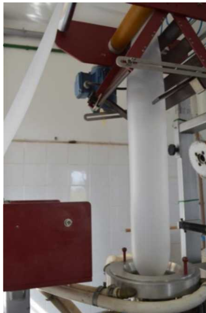
Figura 7 – Extrusão-sopro de filmes de amido/PBAT.
