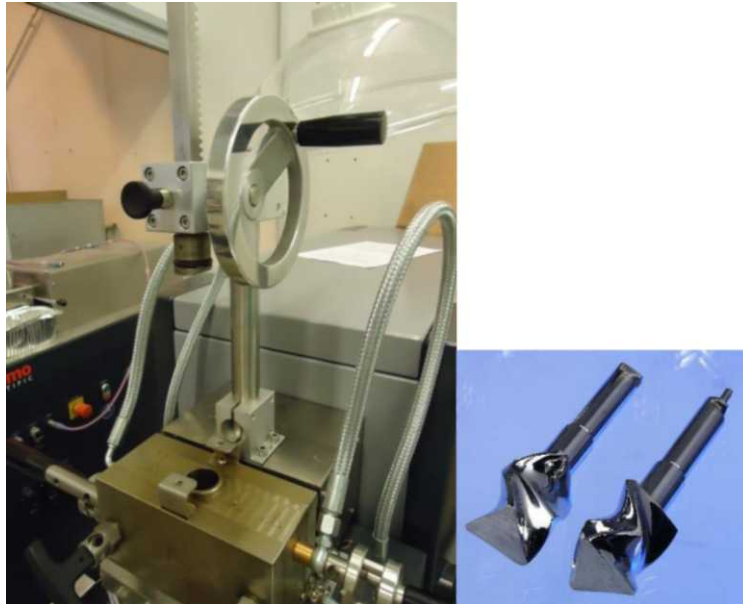
Figura 8 – Misturador interno (Haake) e rotores tipo roller .
