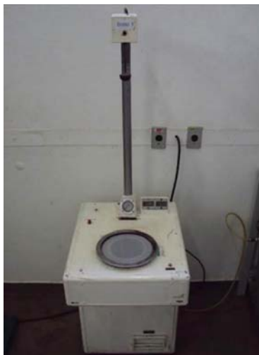
Figura 4 – Foto do ensaio de resistência ao impacto por queda de dardo.
