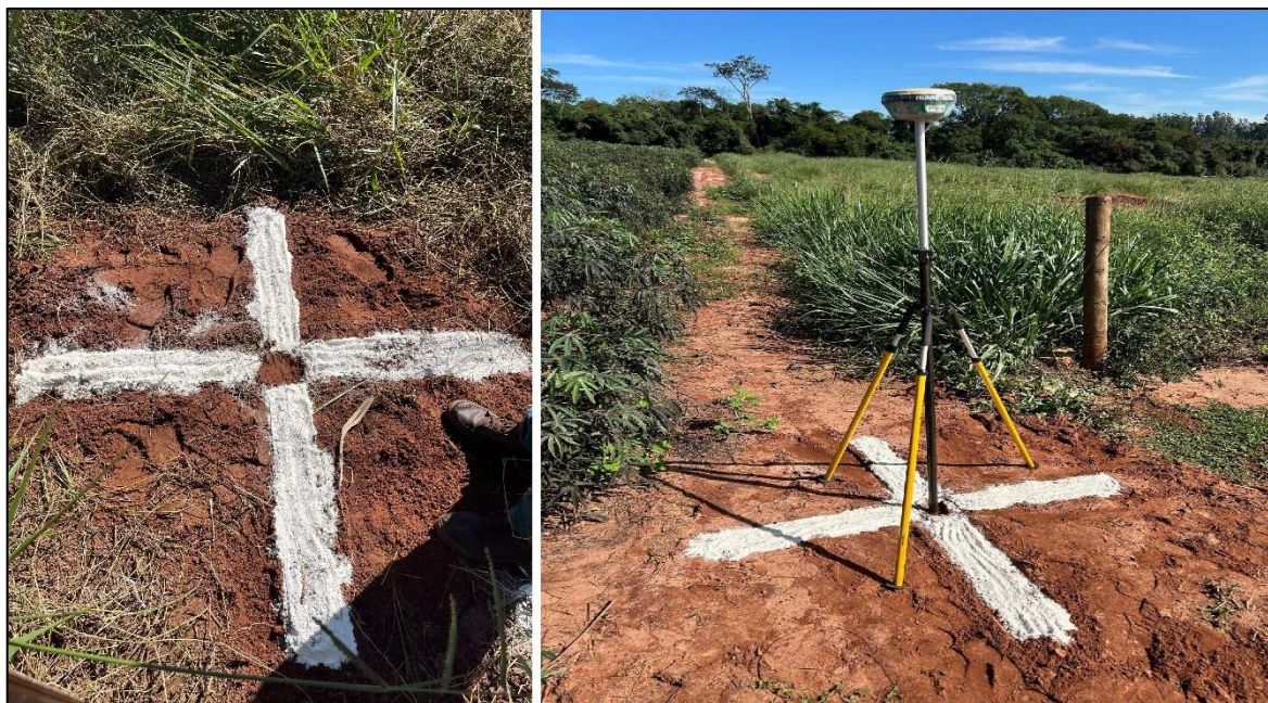
Figura 25 – Pontos de controle e base estacionária para o georreferenciamento.
