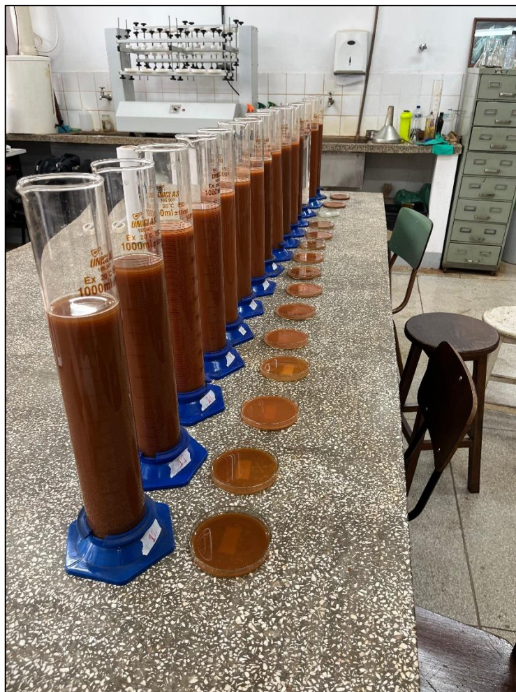
Figura 39 – Preparo de provetas e placas de petri para quantificação da fração argila.
