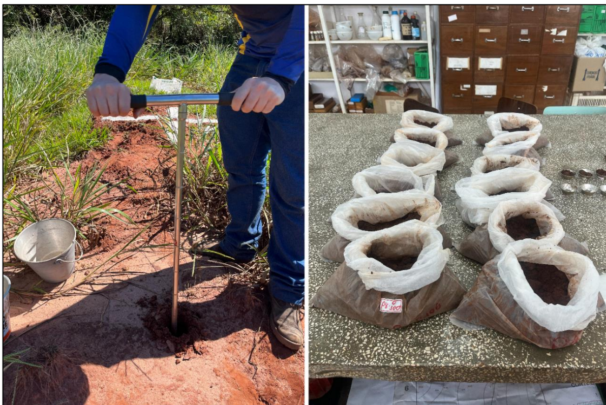
Figura 34 – Coleta de solo com trado holandês e organização de amostras.
