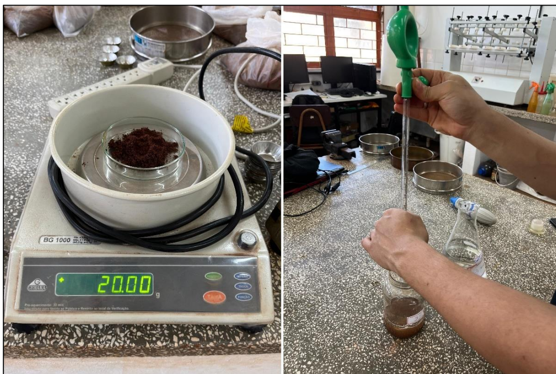
Figura 36 – Pesagem e preparo das amostras com solução dispersante (NaOH).
