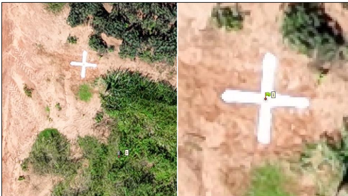
Figura 28 – Correção do marcador e georreferenciamento das imagens.
