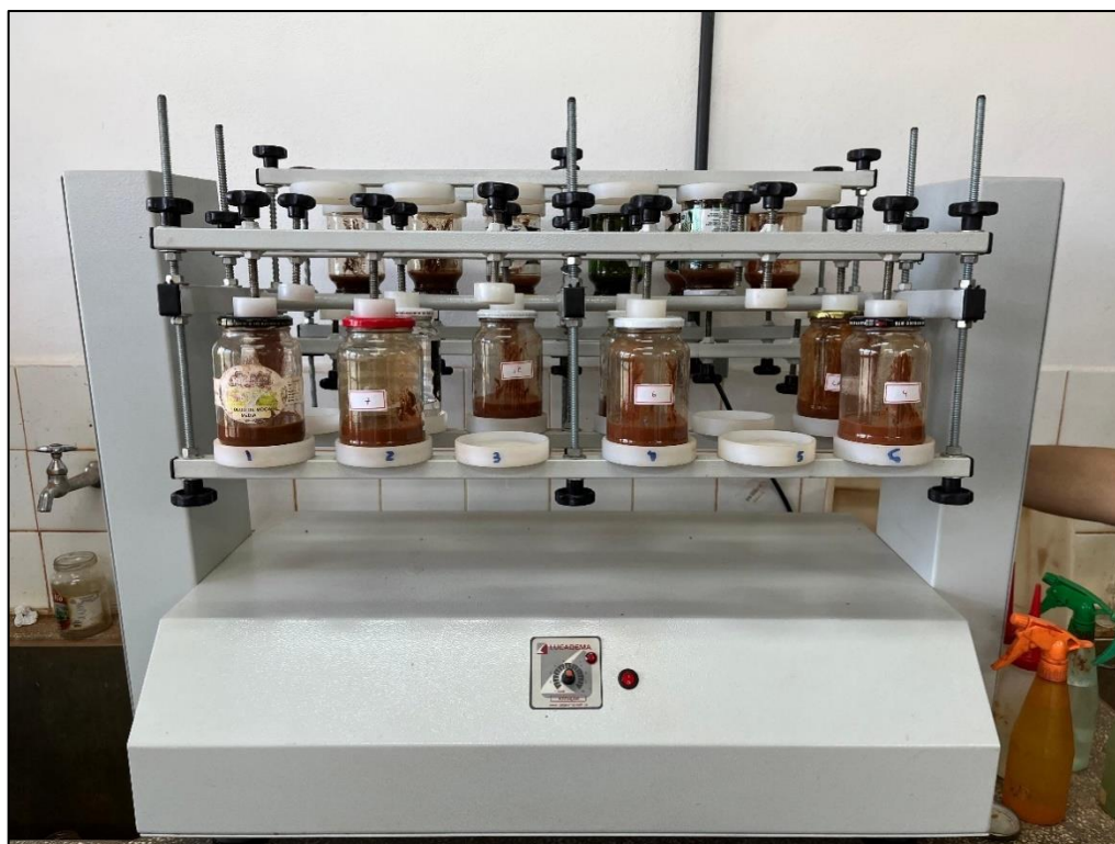
Figura 37 – Organização das amostras em agitador rotativo do tipo Wagner.
