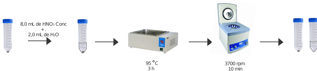
Figura 9 – Esquema dos procedimentos de extração sequencial: Fração 5. Ao resíduo da F4 foram adicionados 8,0 mL de \text{HNO}_3 conc + 2,0 mL de \text{H}_2\text{O} . A suspensão foi aquecida a 95^\circ\text{C} durante 2 h e centrifugada a 3700 rpm durante 10 min para separação resíduo/sobrenadante
