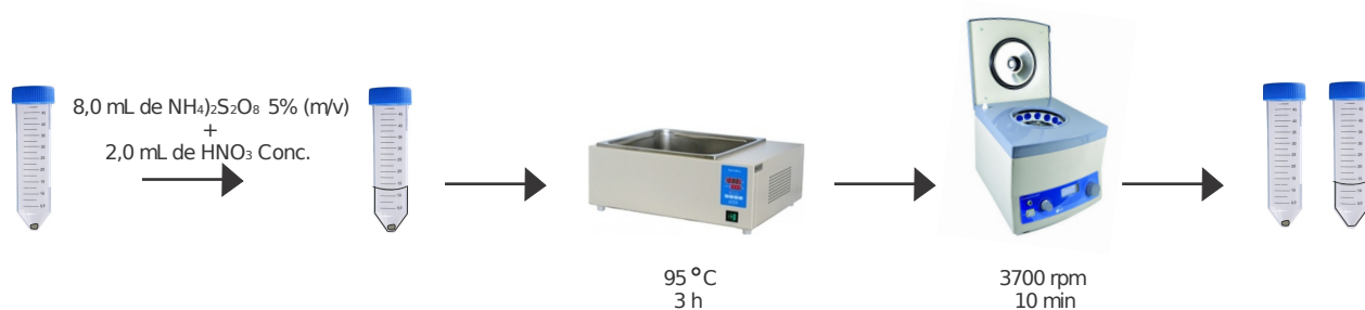
Figura 8 – Esquema dos procedimentos de extração sequencial: Fração 4. Ao resíduo da F3 foram adicionados 8,0 mL de solução de (\text{NH}_4)_2\text{S}_2\text{O}_8 +2,0 mL de \text{HNO}_3 conc. A suspensão foi aquecida a 95°C durante 3 h e centrifugada a 3700 rpm durante 10 min para separação resíduo/sobrenadante
