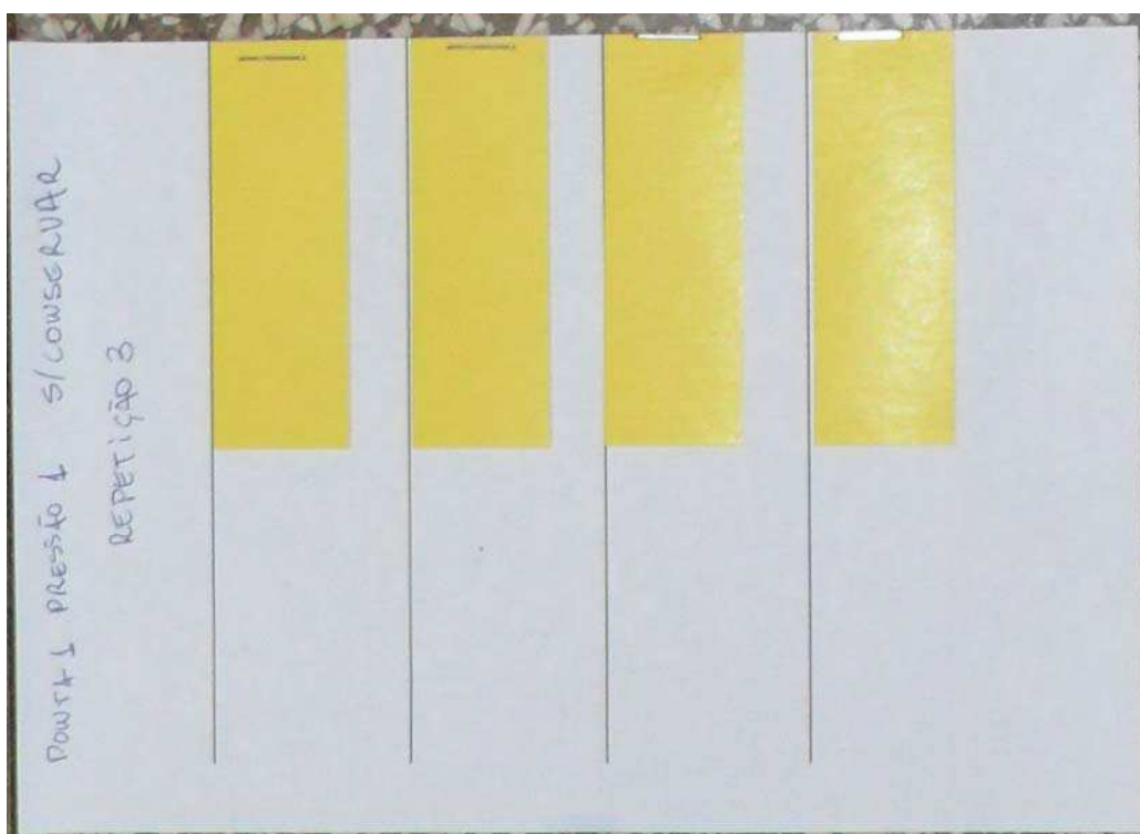
Figura 4.1 – Disposição dos papéis hidrossensíveis sobre a parcela antes da pulverização. Londrina – PR, 2011.
