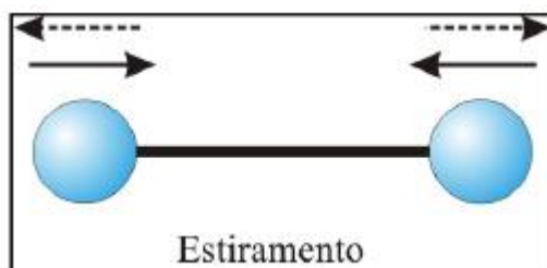
Figura 2.17 – Modo vibracional de estiramento em uma molécula diatômica.
