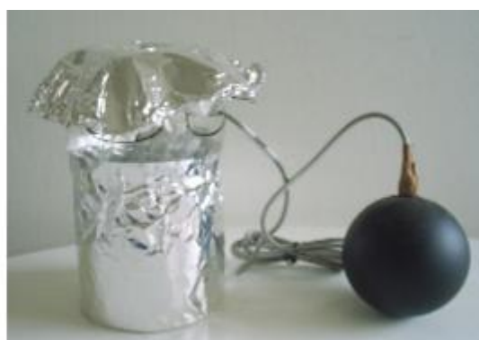
Figura 17 – Proteção contra radiação e Globo negro
