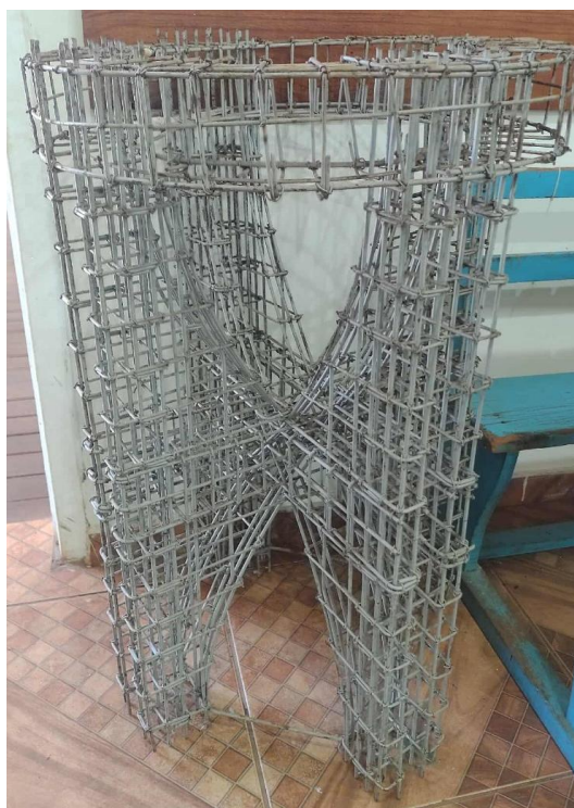
Figura 92 - Maquete da estrutura da torre d'água de Andirá
