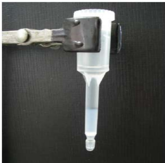
Figura 1 – Coluna de imunoafinidade baseada em suporte ativado Affi-Gel-10 empregando AcM IgG anti-OTA.1
