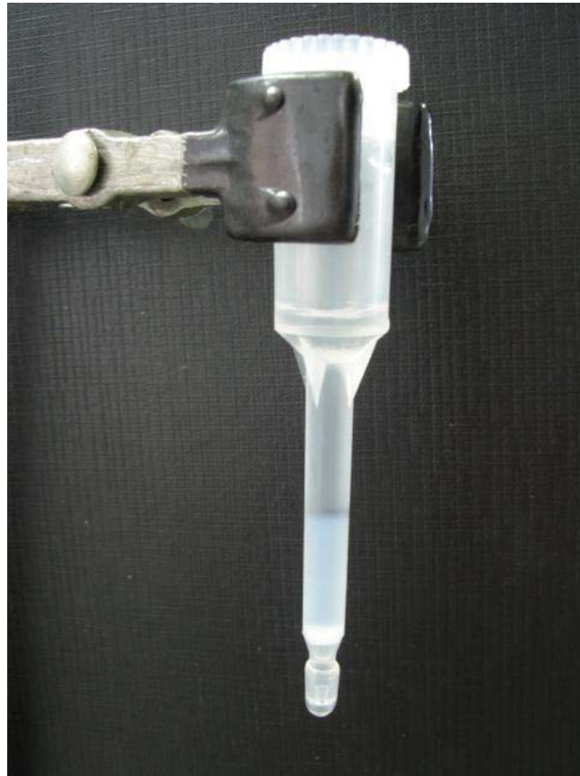
Figura 5 – Coluna de imunoafinidade baseada em suporte ativado Affi-Gel-10 empregando AcM IgG anti-OTA.1.
