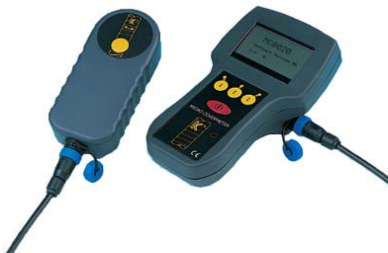
Figura 5 – Pacômetro para realização de ensaios por correntes eddy (extraído de KOLECTRIC, 2011).
