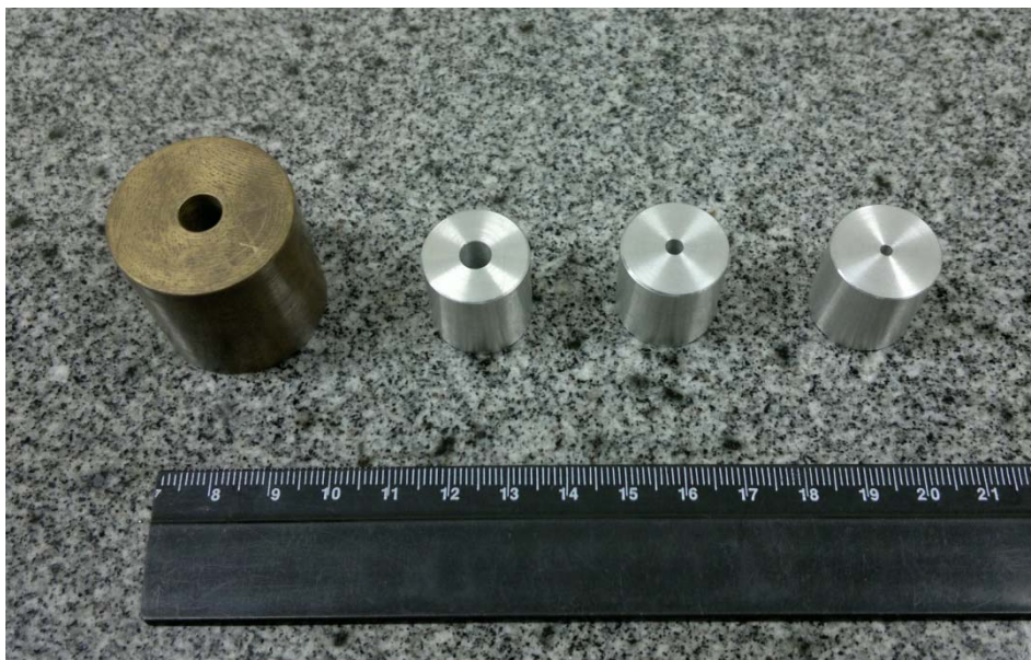
Figura 47 – Colimador de \varnothing 7 \times 30 mm feito de latão (esquerda); colimadores com \varnothing 5 \times 15 mm, \varnothing 3 \times 15 mm e \varnothing 1,5 \times 15 mm feitos de alumínio.
