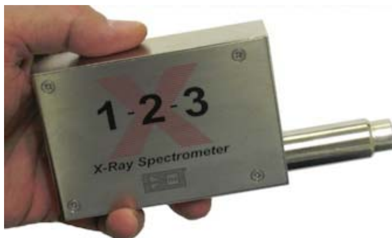
Figura 40 – Visão do detector de CdTe modelo X-123 da Amptek Inc. usado neste trabalho (extraído de AMPTEK, 2011).
