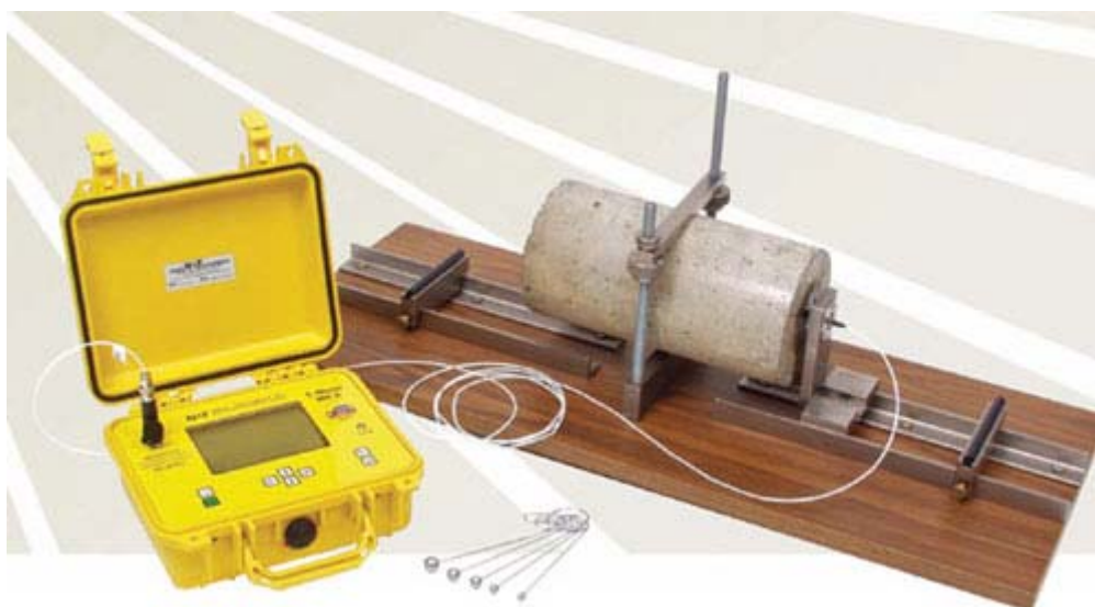
Figura 4 – Equipamento para a realização do ensaio de frequência ressonante em concreto modelo E-Meter MK II (extraído de QUALITEST, 2011).
