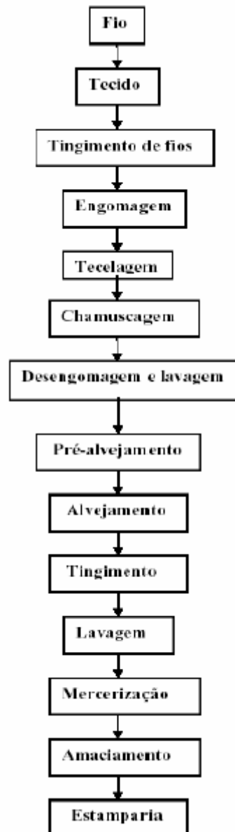
Figura 4 – Fluxograma das etapas de uma indústria têxtil para produção de tecido (PERES; ABRAHÃO, 1999 apud OLIVEIRA, 2006).
