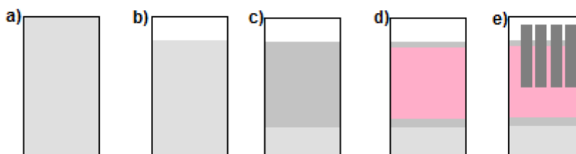
Figura 3.6 - Representação esquemática para construção do dispositivo emissor de luz.
