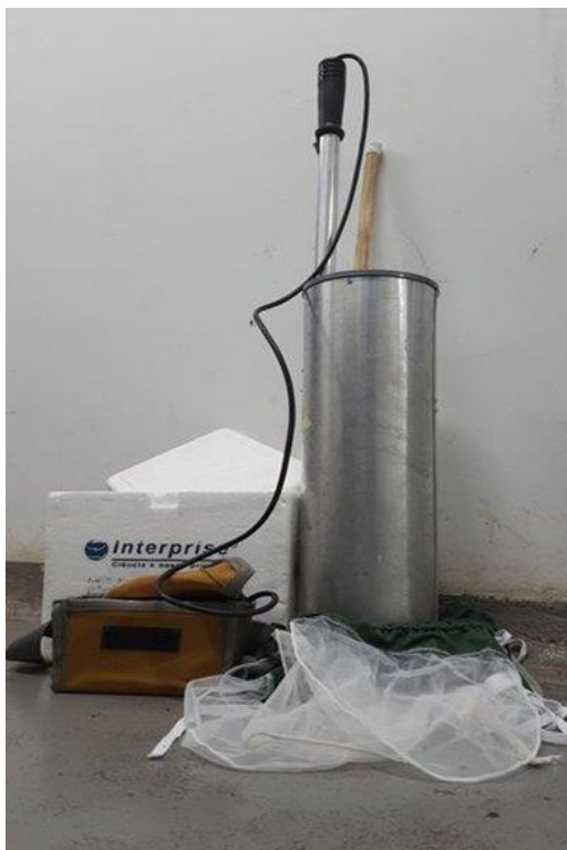
Figura 11 - Aspirador de Nasci modificado, ferramenta utilizada para captura de culicídeos adultos.
