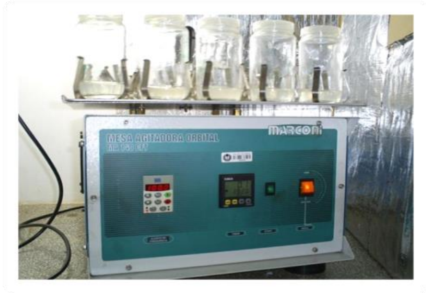
Figura 5- Agitador Orbital, para cultivo in vitro com luz contínua, frascos de 300 ml contendo semente e tratamentos de glutamina a 100 rotações minuto -1 , por oito dias.
