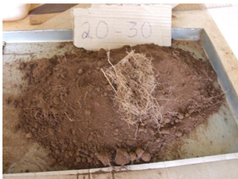
Apêndice E.4 – Separação radicular da camada 20-30 cm
