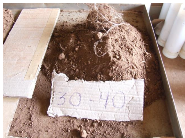
Apêndice F.5 – Separação radicular da camada 30-40 cm
