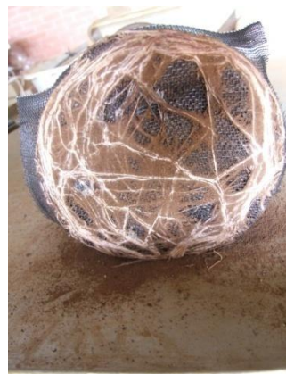
Apêndice E.2 – Distribuição radicular no fundo da coluna
