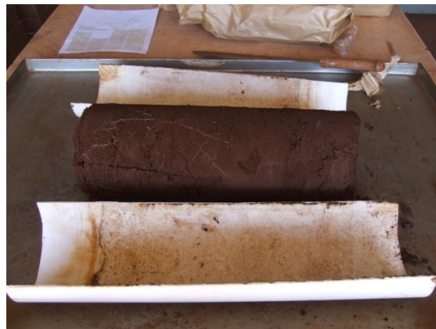
Apêndice D.2 – Canos serrados para o auxílio do desmonte e para o tombamento das colunas
