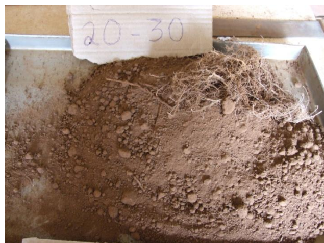
Apêndice F.4 – Separação radicular da camada 20-30 cm
