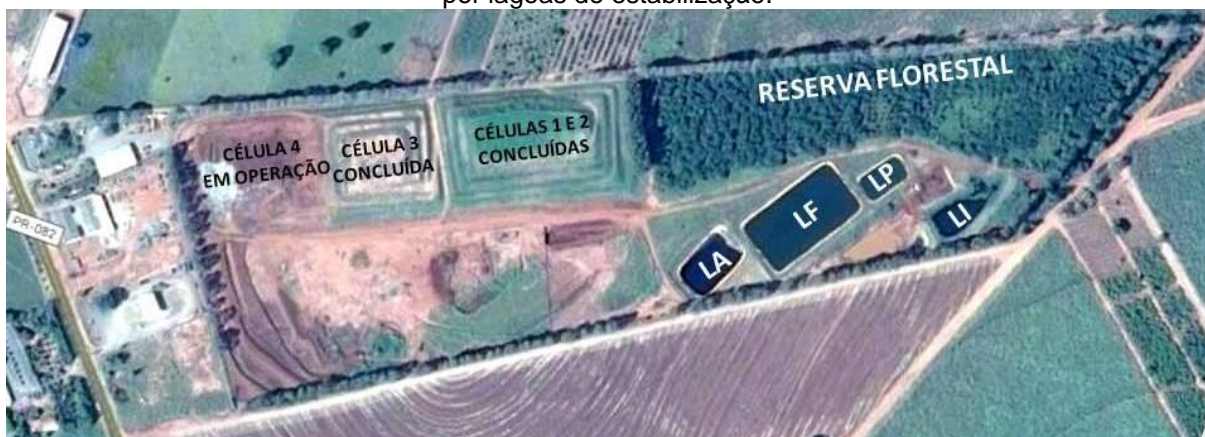
Figura 5 – Imagem do aterro sanitário de Cianorte-PR, com identificação das células concluídas (células 1, 2 e 3), da célula em operação (célula 4), da reserva florestal, e do sistema de tratamento por lagoas de estabilização.
