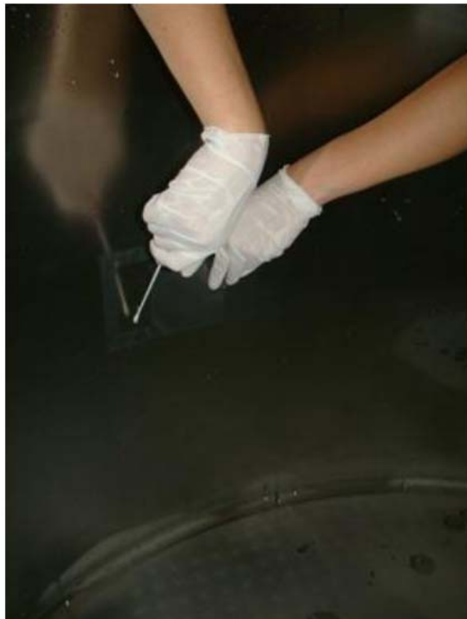
Figura 4 – Utilização do Quick Swab 3M™ em tanque de equilíbrio antes do pasteurizador, no laticínio B, 2011.
