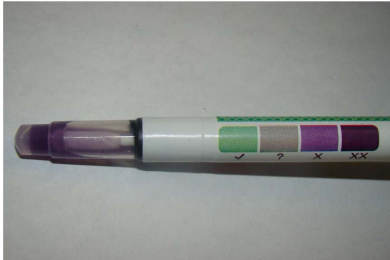
Figura 2 – Clean-Trace™ Surface Protein Plus mostrando resultado que indica resíduos de proteína na superfície amostrada.
