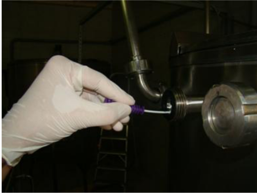
Figura 3 – Clean-Trace™ Surface Protein Plus 3M™ sendo aplicado na tubulação de entrada de leite no tanque de equilíbrio antes da empacotadeira, no laticínio A, 2011.
