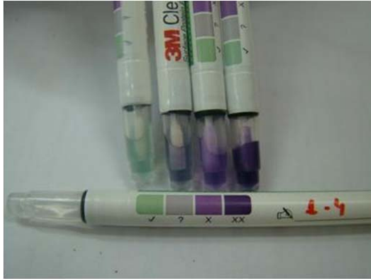
Figura 5 – Escala de cores obtidas no teste in vitro comparada com a escala do rótulo do Clean-Trace™ , Londrina, 2011.
