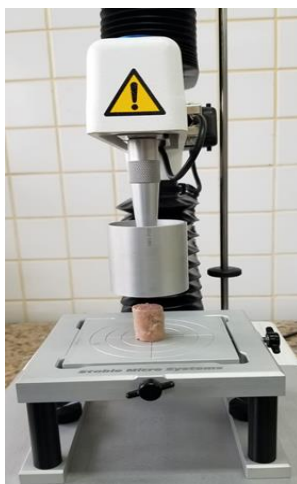
Figura 7 – Amostra de salsicha para análise de TPA no equipamento Texture Analyser TA.XT plus
