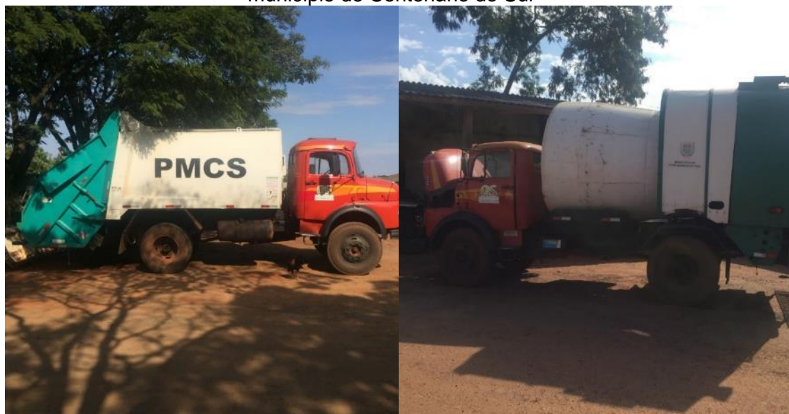
Figura 5.2 - Caminhões coletores compactadores utilizados na coleta convencional do município de Centenário do Sul
