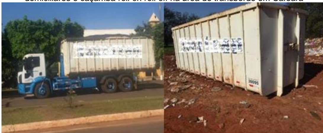
Figura 5.5 - Caminhão da empresa contratada utilizado no transporte dos resíduos domiciliares e caçamba roll on roll off na área de transbordo em Cafeara
