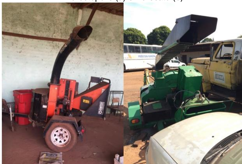
Figura 5.17 - Trituradores móveis para resíduos de podas dos municípios de Florestópolis (a) e Porecatu (b)
