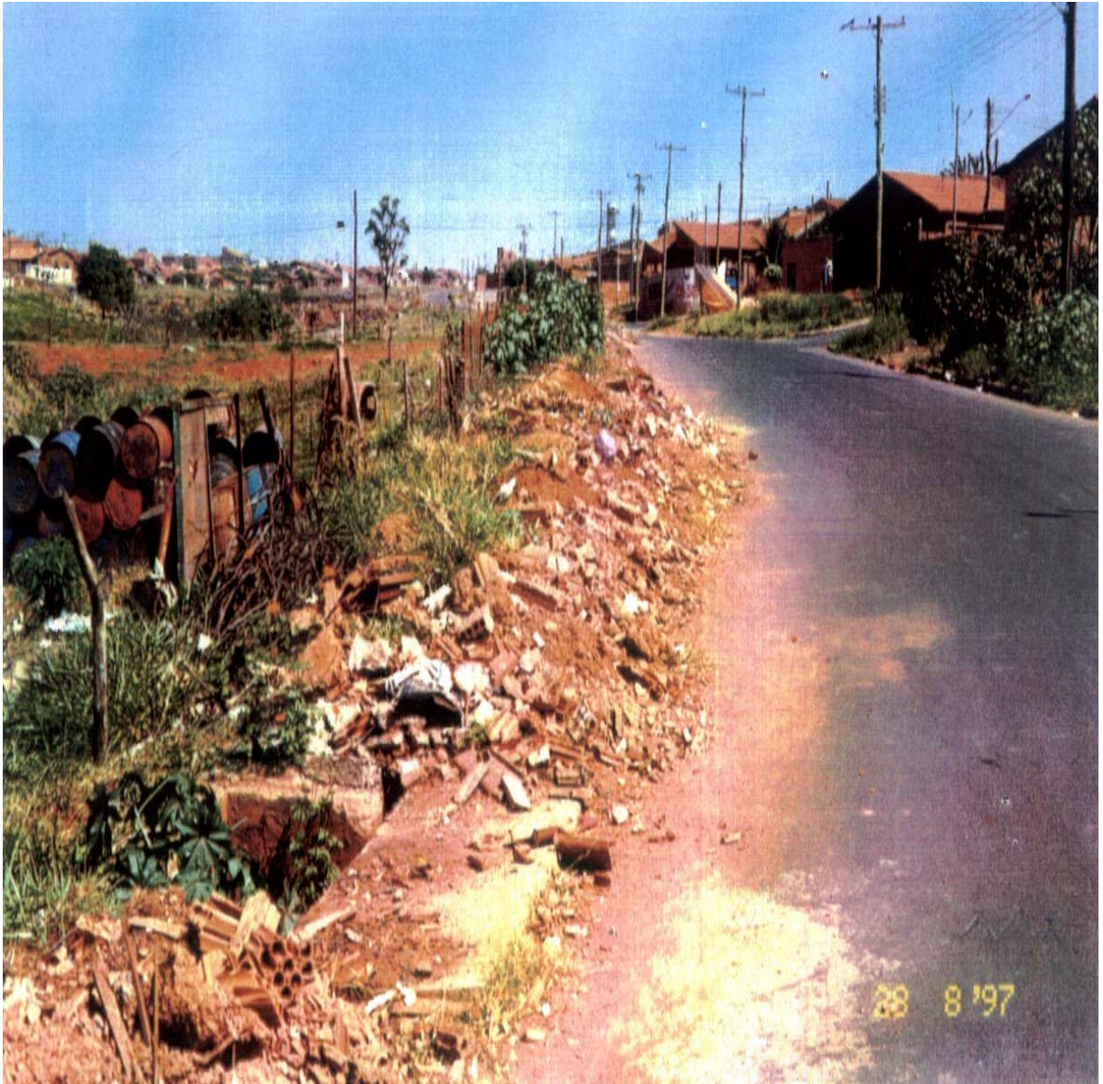
Figura 17 – Deposição irregular de RCC ao longo de passeio e rua no Município de São José do Rio Preto – 1997
