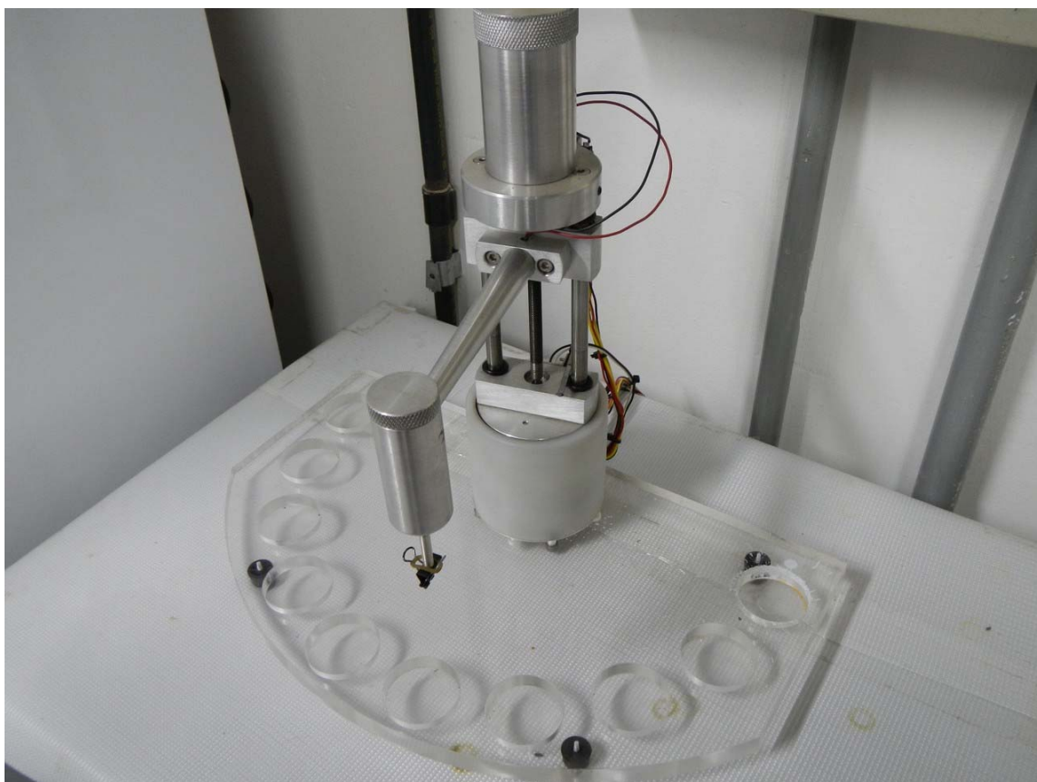
Figura 2.2 – Braço robótico para a deposição de filmes orgânicos pela técnica LbL.
