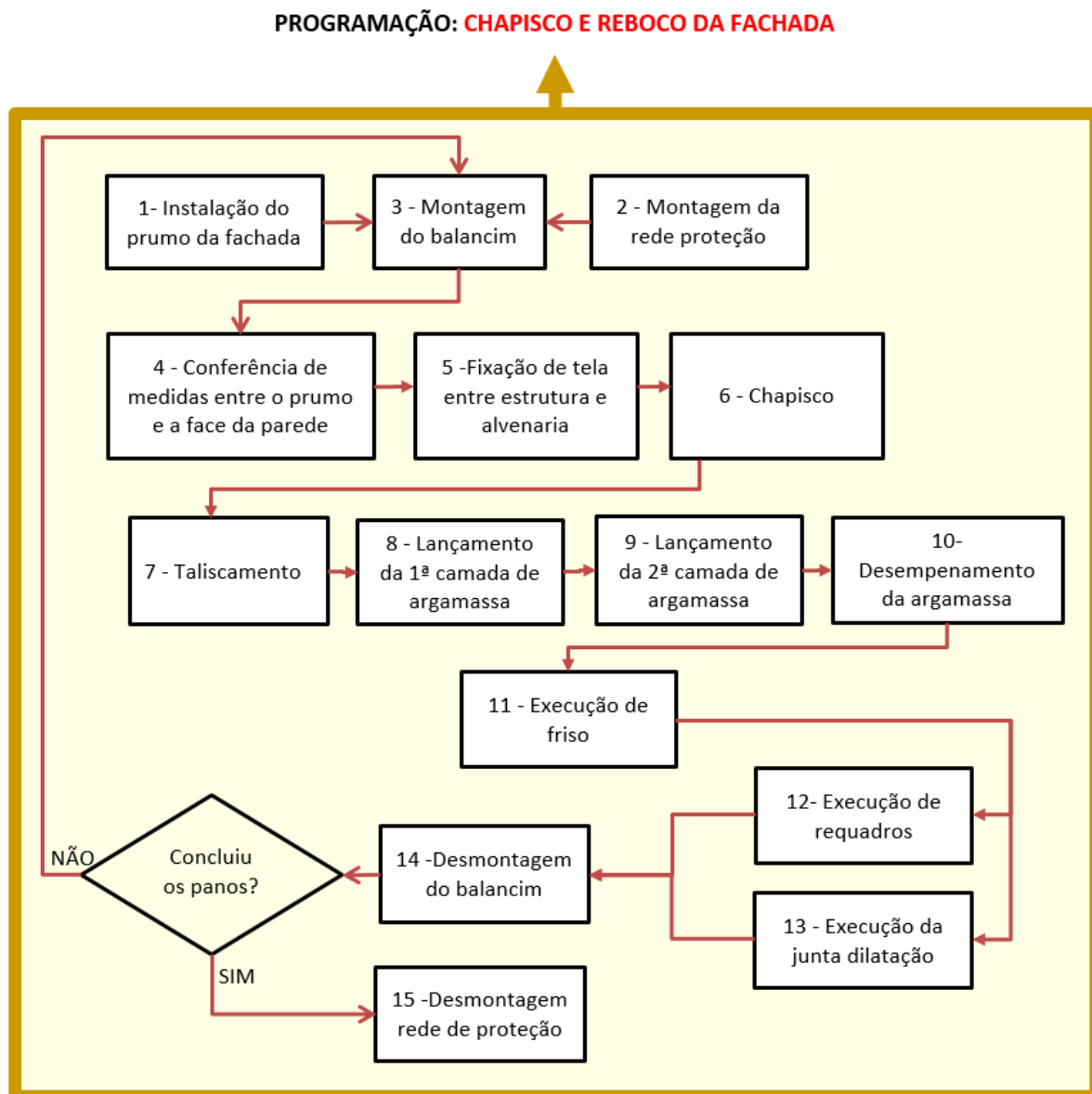
Figura 38: Agrupamento das macro operações do serviço de emboço da fachada conforme a programação
