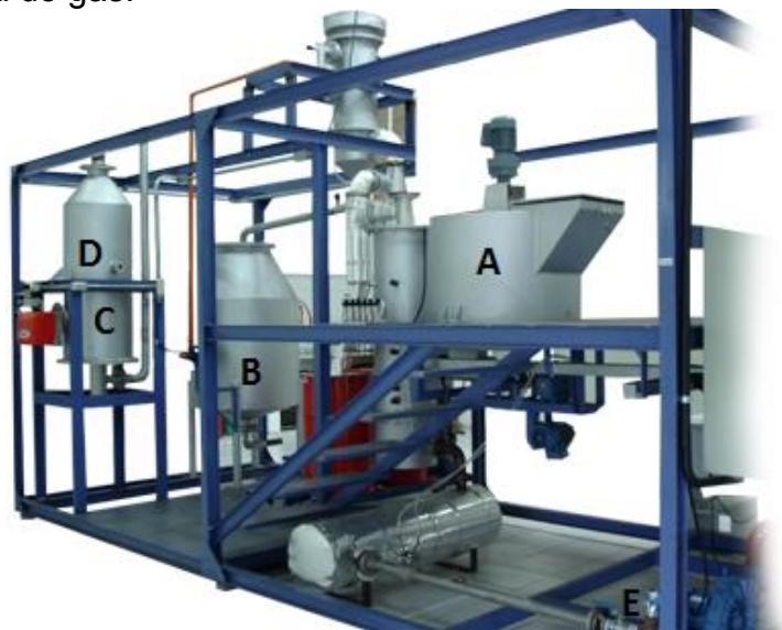
Figura 6 - Planta de pirólise rápida em leito fluidizado: (A) reator; (B) saída de carvão; (C) saída do bio-óleo leve; (D) saída do bio-óleo pesado; (E) saída do gás.
