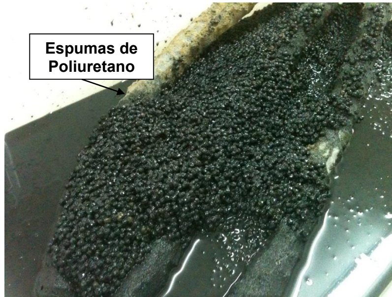
Figura 11 - Fotografia do lodo utilizado na inoculação do reator anóxico/anaeróbico
