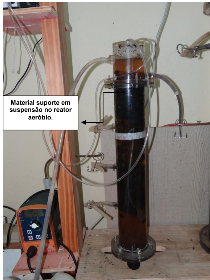
Figura 10 - Reator aeróbio de leito móvel (MBBR), com o material suporte em suspensão
