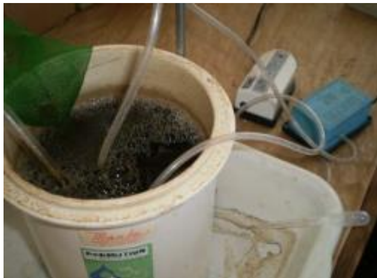
Figura 13 - Reator aeróbio de bancada alimentado com efluente da Avícola Dacar para desenvolvimento do inócuo
