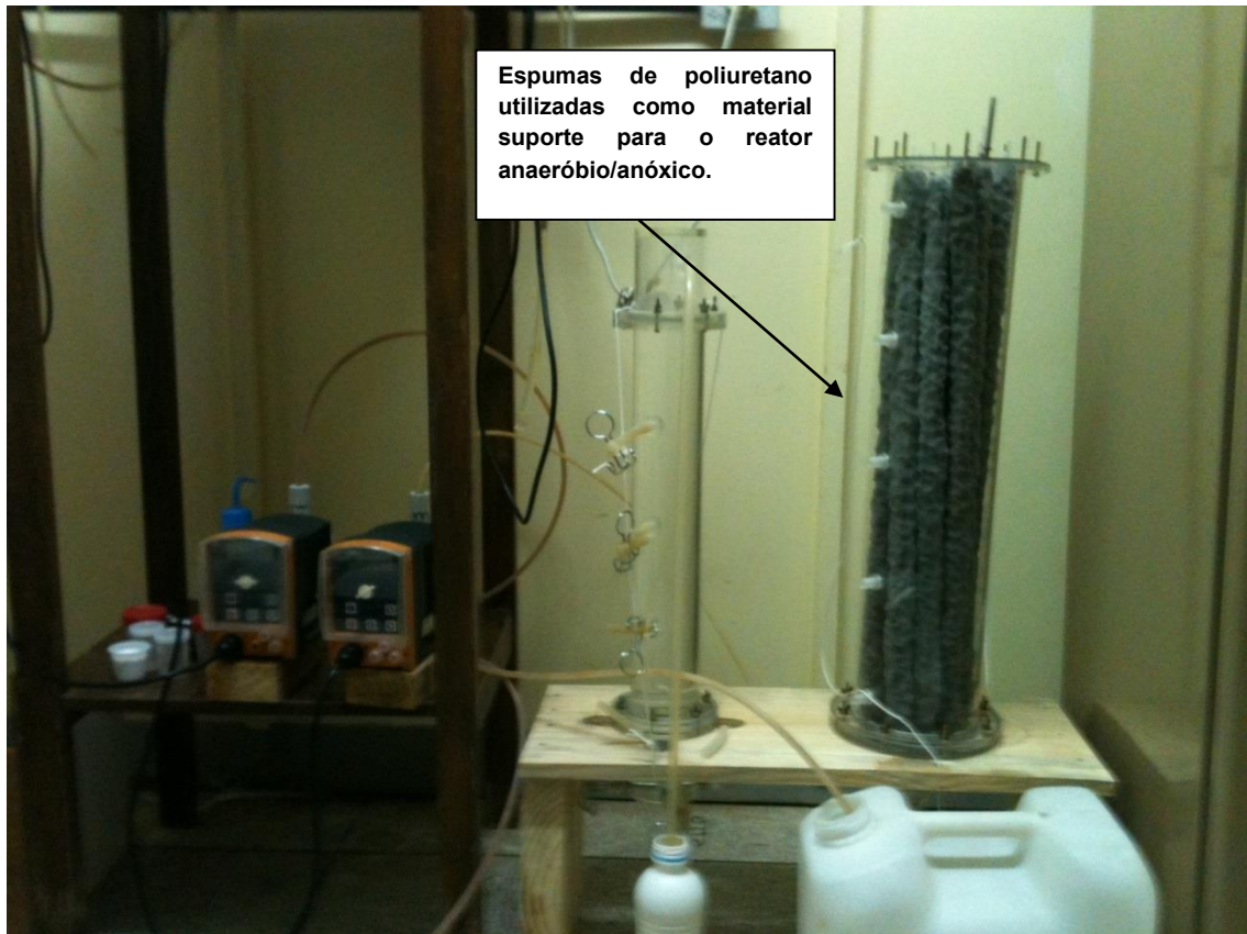
Figura 8 - Foto do material suporte do reator anóxico de leito estruturado
