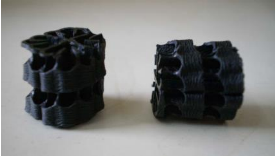
Figura 9 - Meio suporte do reator aeróbio para adesão do biofilme
