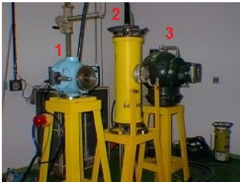
Figura 37 – Tubo de Raios X e Fontes Radioativas: 1. Fonte de Césio-137, 2. Tubo de Raios X e 3. Fonte de Cobalto-60.
