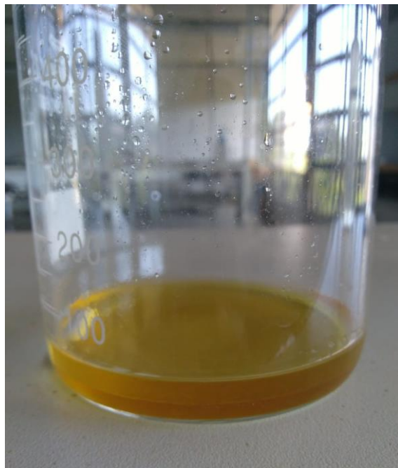
Figura 20- Béquer contendo o produto final do biodiesel obtido pelo experimento após lavagem com água.
