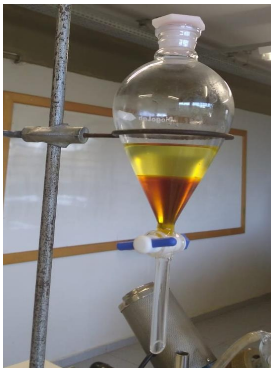
Figura 18- Separação do biodiesel e glicerol utilizando funil de separação.
