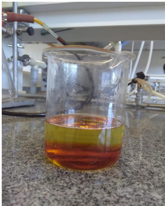
Figura 17- Béquer contendo o produto da mistura do etanol com óleo vegetal usado e hidróxido de potássio, após 50 minutos de agitação
