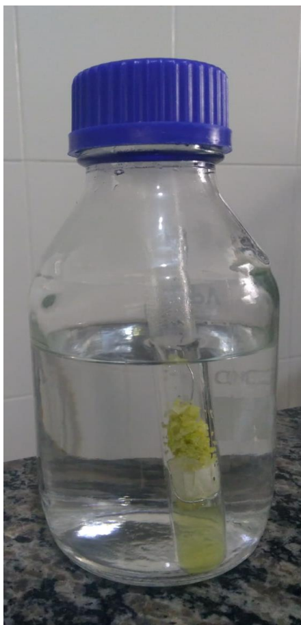
Figura 13- Imagem do experimento da extração de limoneno de casca de limão, utilizando CO 2 líquido como solvente verde.
