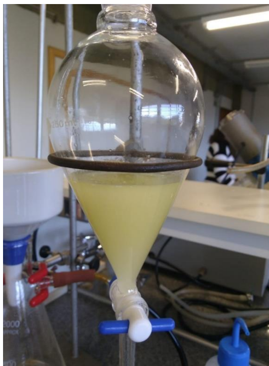
Figura 19- Lavagem do biodiesel com água após remoção do glicerol pelo funil de separação.
