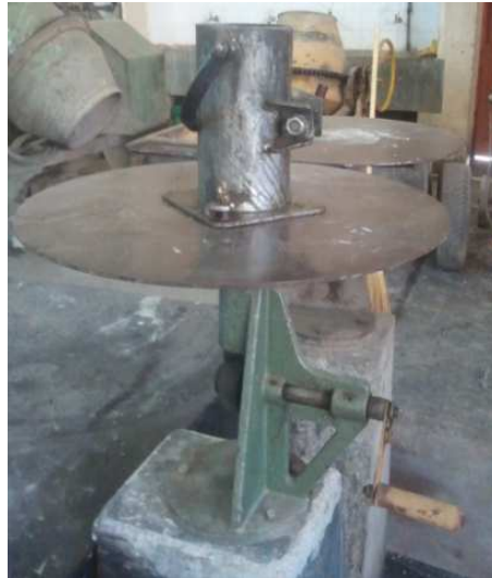
Figura 3.4 – Procedimento de adensamento dos corpos de prova de 100 mm por 200 mm
