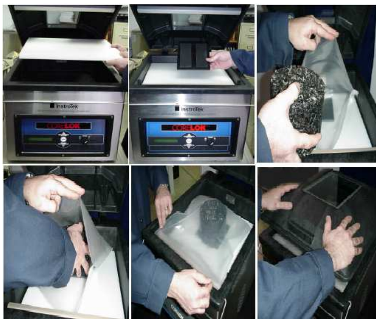
Figura 2.3 – Procedimento de instalação de amostras na máquina CoreLok
