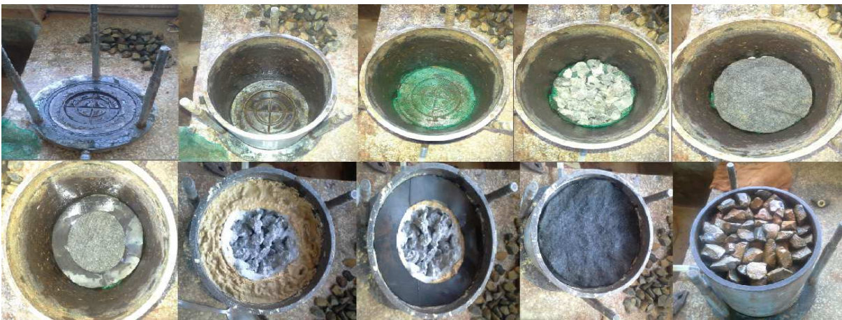
Figura 3.9 – Montagem do ensaio de permeabilidade
