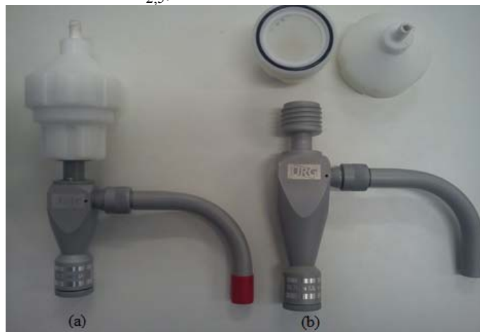
Figura 6 – Conjunto impactadores ciclones e porta-filtros: (a) MP 1,0 (b) MP 2,5 .
