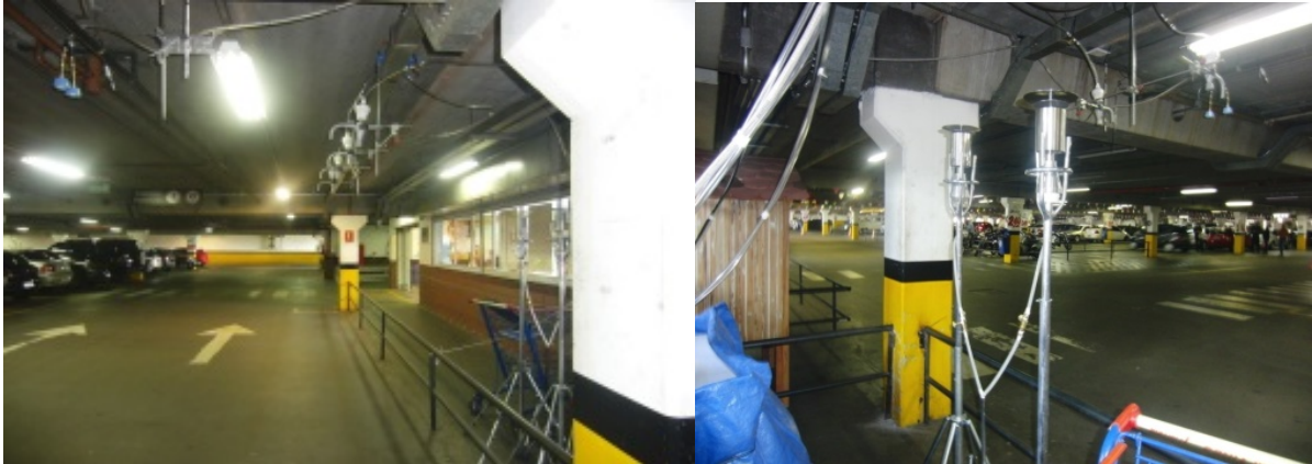
Figura 5 - Imagens do ambiente interno do estacionamento comercial, com os amostradores instalados
