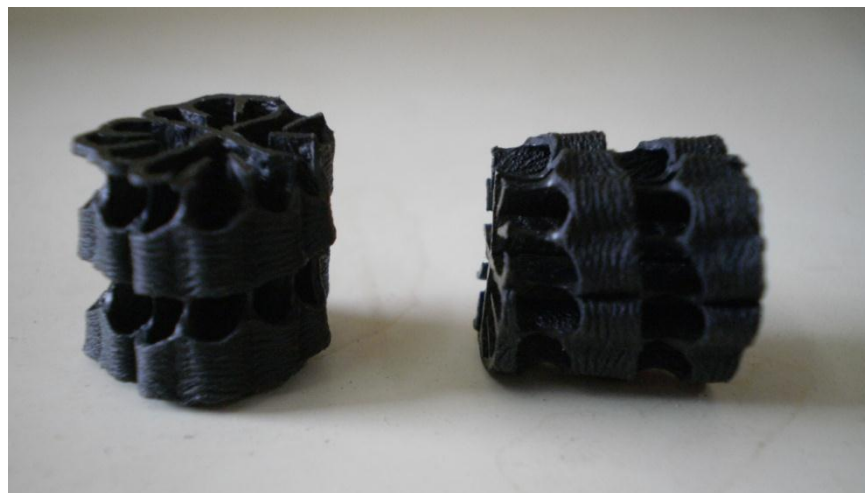
Figura 4.4 Meios suportes para adesão do biofilme (biomédia).
