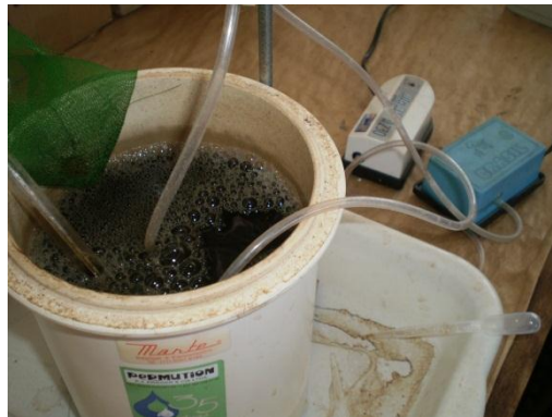
Figura 4.1. Reator em batelada alimentado com lixiviado para desenvolvimento do inóculo
