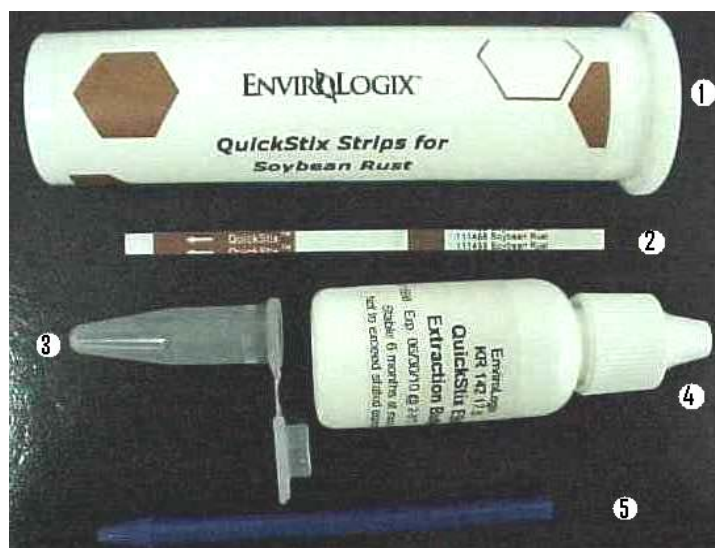
Figura 2 – Componentes do Kit QuickStix ® para ferrugem em folhas de soja. 1-tubo dessecante; 2-fitas Quickstix ® ; 3-mini tubo de coleta; 4-solução tampão EB6; 5-pistilo.
