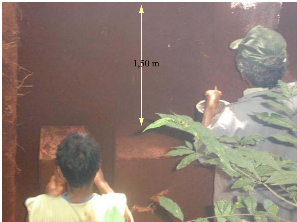
Figura 3.4 – Coleta amostra indeformada profundidade 1,5 m
