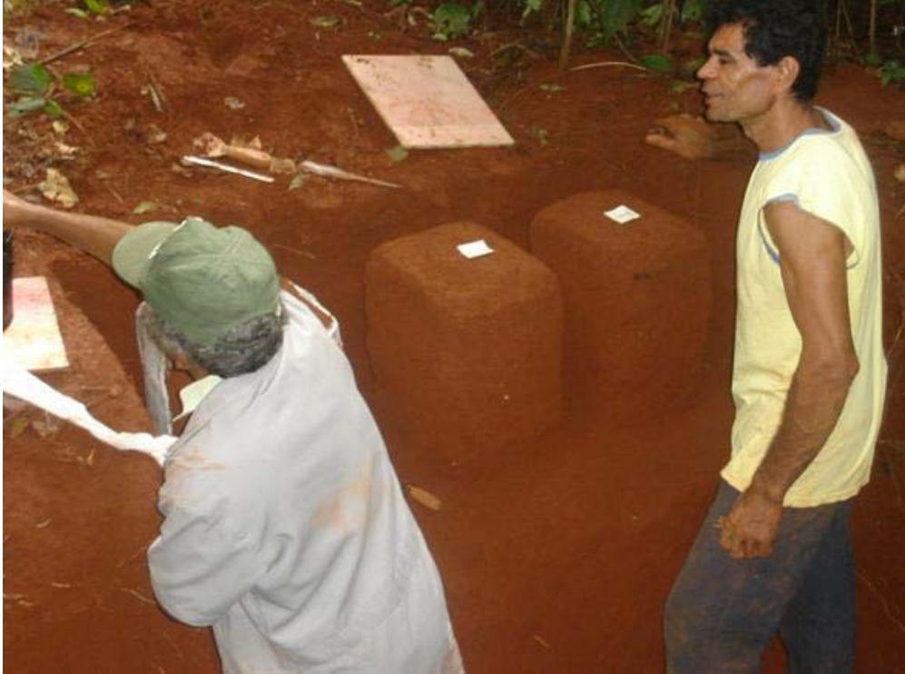
Figura 3.3 – Coleta de amostra indeformada da profundidade de 0-20 cm
