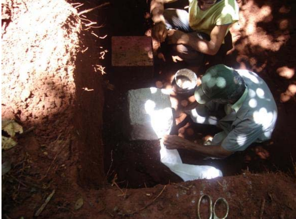
Figura 3.5 – Proteção da amostra com tecido e parafina
