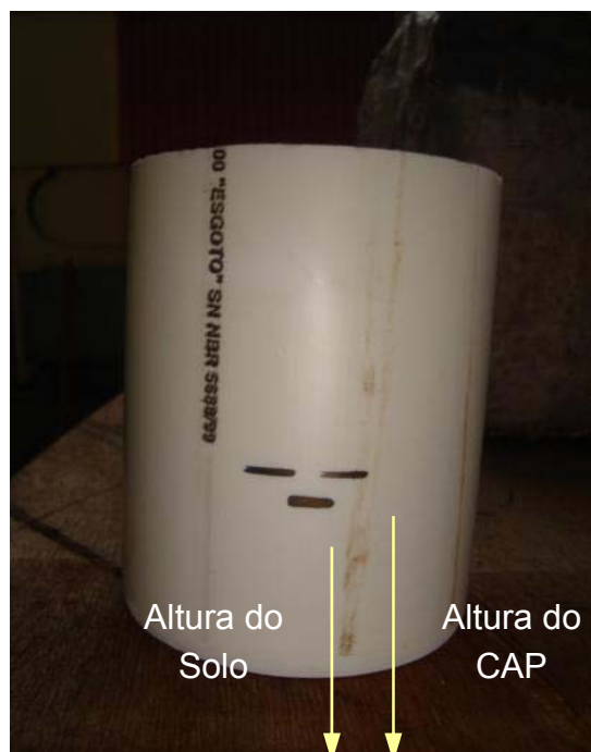
Figura 3.7 – Marcação no tubo de PVC
