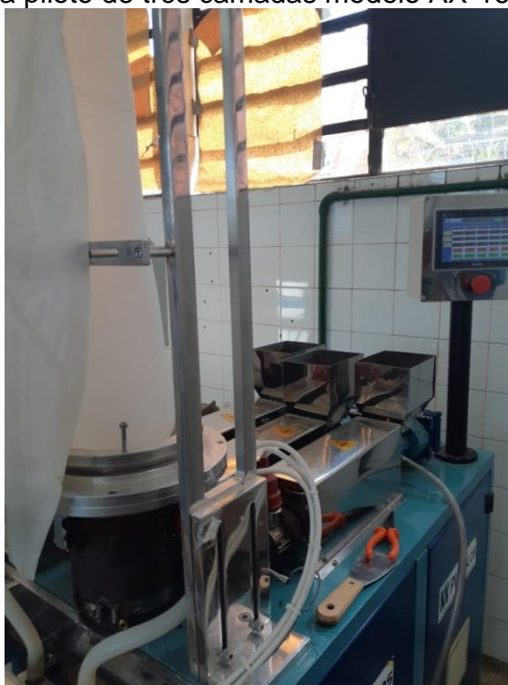
Figura 1 – Coextrusora piloto de três camadas modelo AX-16L/D26
