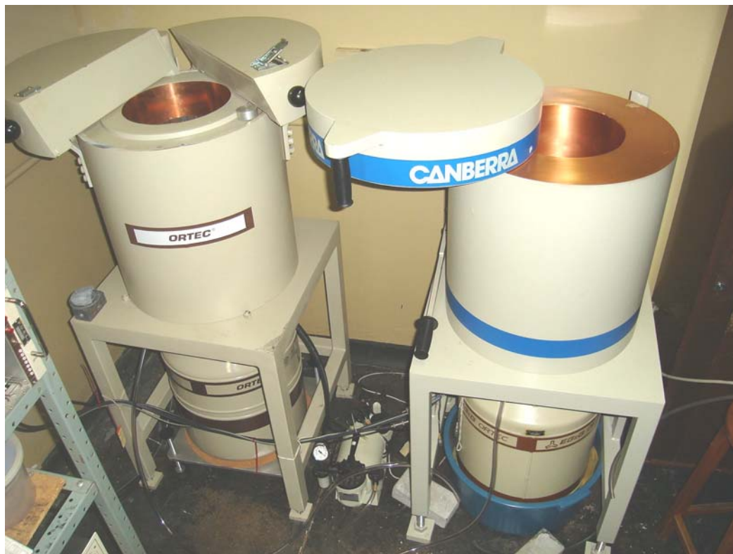
Figura 17 – Blindagens da Canberra (Modelo 747) e da Ortec (HPLBS1) com o dewar do detector.
