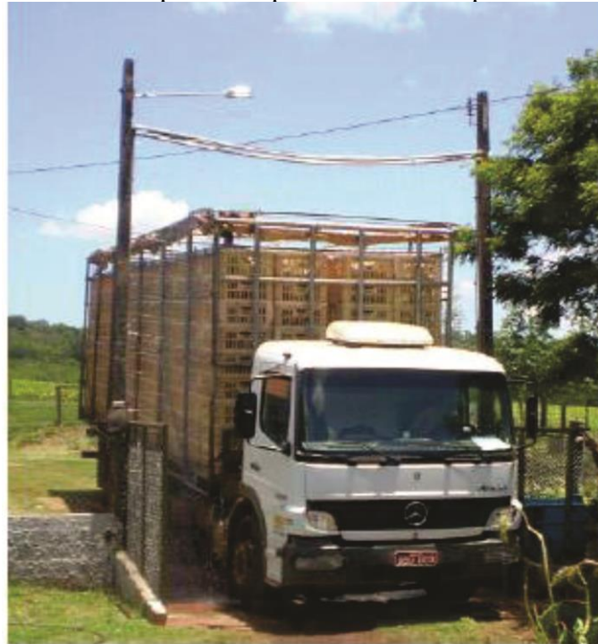
Figura 6 - Caminhão utilizado para transporte de aves em países de clima tropical.
