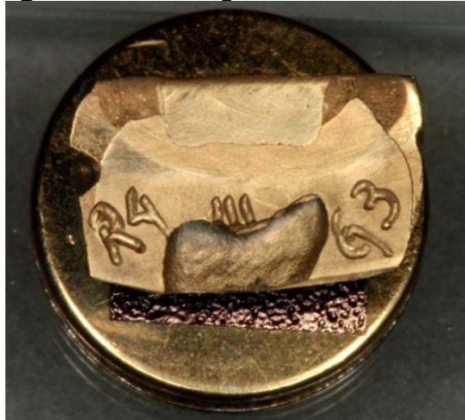
A) Fotografia de uma amostra do grupo 3 aderida ao stub após metalização com ouro.
