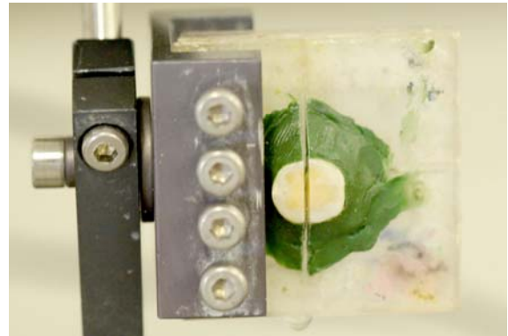
B) Detalhe do corte sagital da amostra na máquina de corte Labcut.
