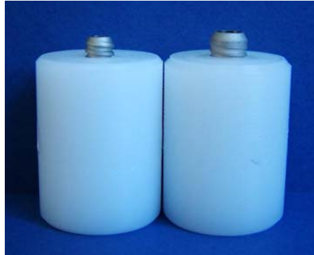
Figura 8 - Implantes do GI e GII montados em cilindro de Poliacetal
