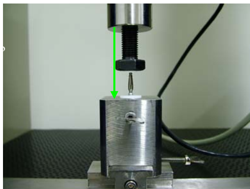
Figura 10 - Corpo de prova no dispositivo metálico para acionamento a 0°
