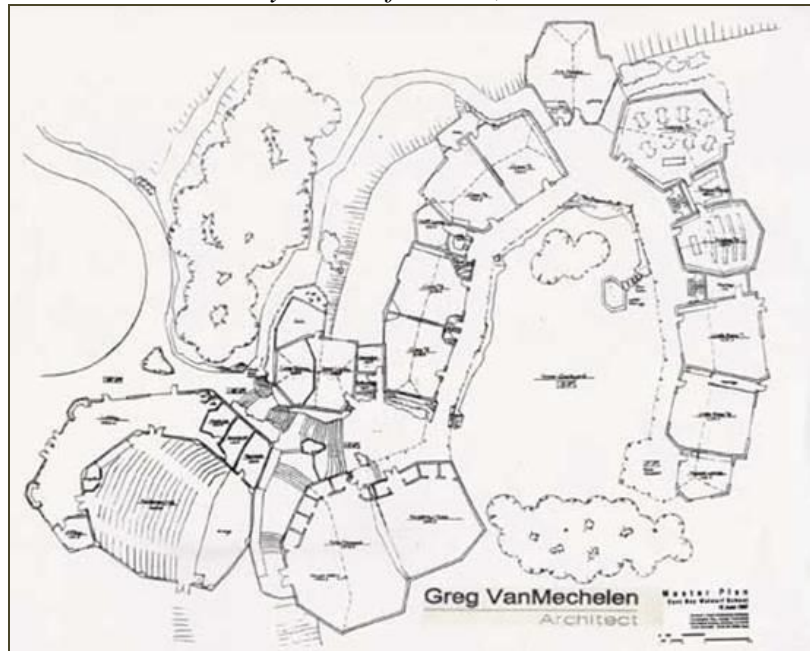
Figura 1 – Edifícios escolares articulados de modo a envolver um ambiente externo comunitário. East Bay Waldorf School , Estados Unidos.
