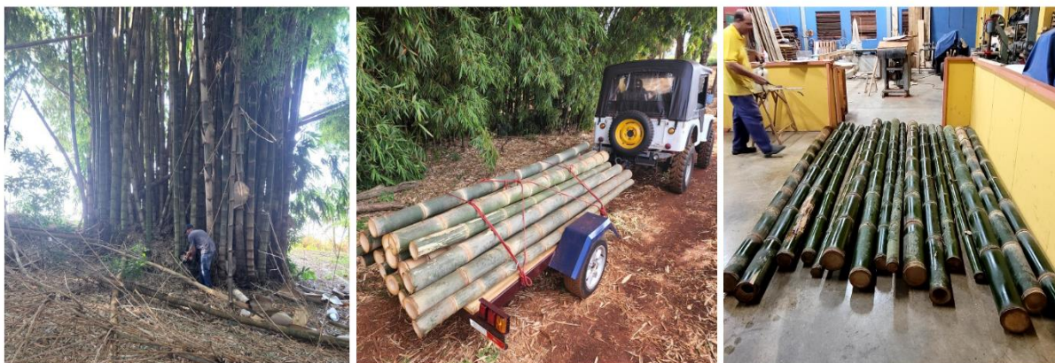
Figura 8 - Corte, transporte e imunização dos colmos de bambu gigante
